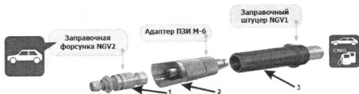
Рисунок 1 – Принцип использования переходника
