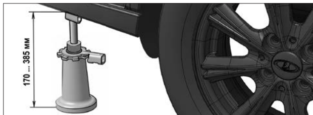
Рис. 3. Положение домкрата при замене колеса
