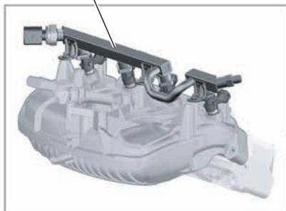
Электронный регулятор давления газа с датчиком давления в баллонах G400 и клапаном высокого давления для работы на газе N372
