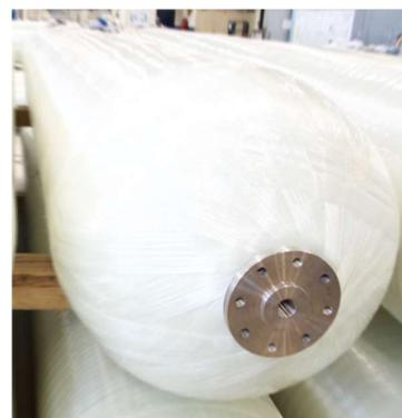
Использование таких материалов исключает проблемы с коррозией, а также гарантирует отсутствие гальванической коррозии.
