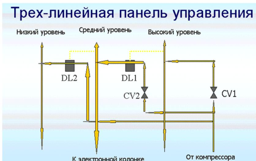
Для наполнения каскада ресиверов в необходимой последовательности между компрессором и каскадом ресиверов используется панель приоритетного распределения газа.
